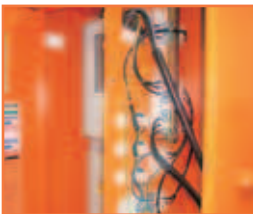
Servicefreundliches, um über 90° schwenkbares Abnehmerteil
